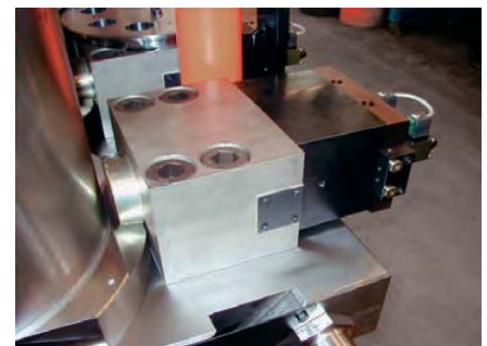
Elementos de sujeción en forma de cuña en una prensa de forja
